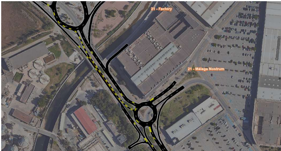
Figura 11. Extensión de cola en la nueva glorieta frente a Málaga Nostrum en el largo plazo (HPT).
