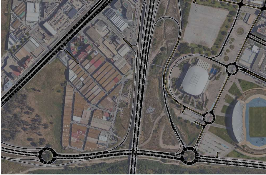
Figura 6. Alternativa a medio plazo (Escenario MP) con nuevas glorietas y reordenación de sentidos.
