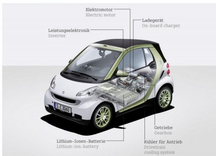
Un **vehículo eléctrico** de batería (abreviado "VEB") es un vehículo de propulsión alternativa impulsado por un motor eléctrico alimentado por energía eléctrica proveniente de una batería.
